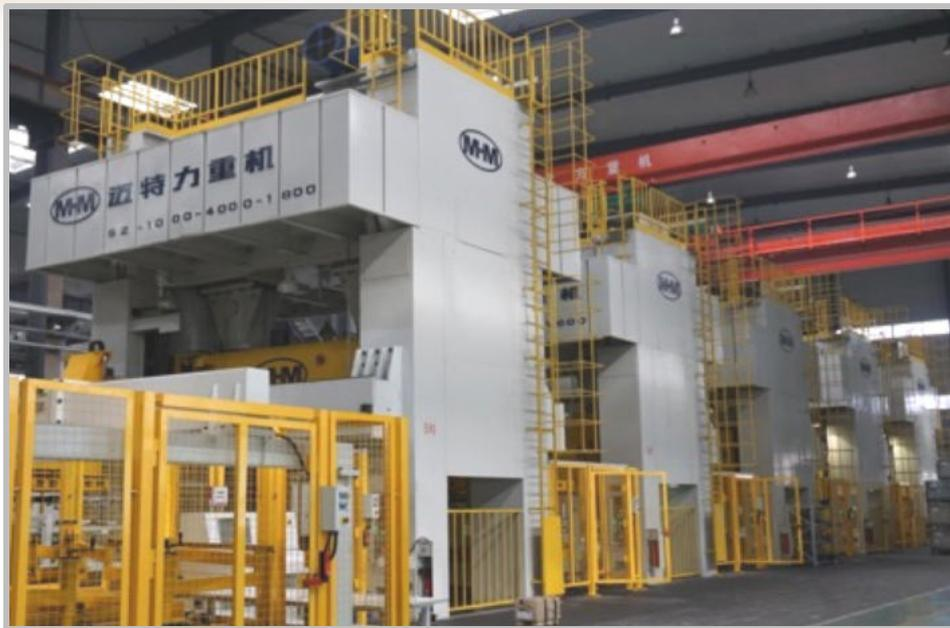
Pressenkraft E01: 10.000KN
