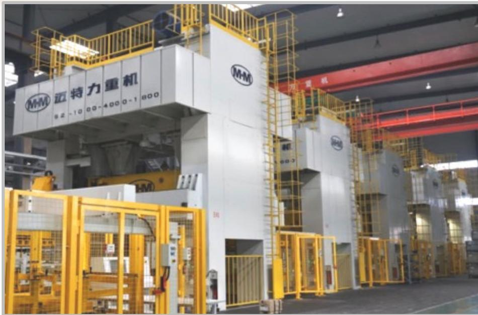
Pressenkraft D05: 4.000KN
