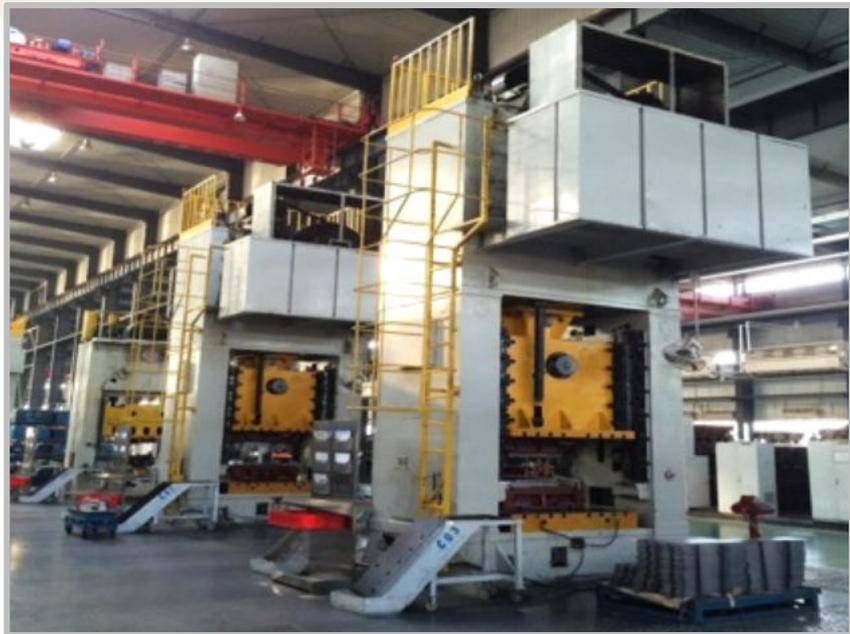
Pressenkraft C03: 4.000KN
